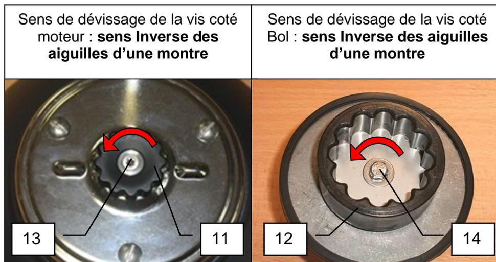
**REMARQUES :** Pour les versions de N°37 antérieures à 2012, il faut tourner la vis (13) dans le **sens des aiguilles d'une montre** pour retirer l'accouplement souple (11).
