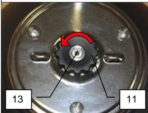
Sens de dévissage de la vis coté Bol : **sens Inverse des aiguilles d'une montre**
